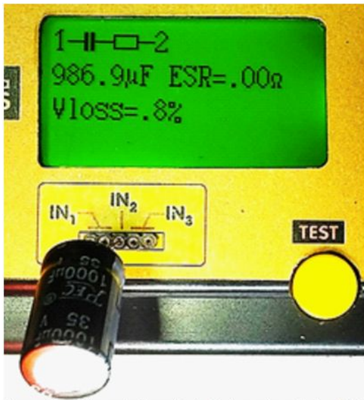
Figura 14a. Valores de Capacidad, Resistencia en Serie o ESR y pérdida de voltaje de un condensador de 1.000µF Bueno.
