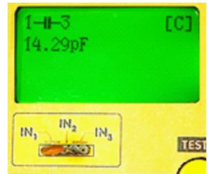
Figura 12b. El Multítester muestra ahora la capacidad real.
