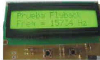
Función Generador 15734,35Hz
